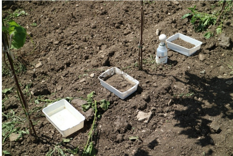
Slika 5a Posuda sa vodom, posuda sa zemljištem1, mikrolizimetar i posuda sa zemljištem2.
