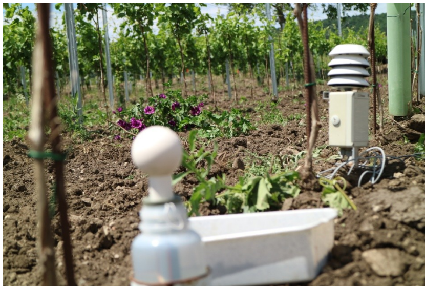
Slika 5b Mikrolizimetar, posuda sa zemljištem2 i nosač za merenje temperature i vlažnosti vazduha pri tlu.
