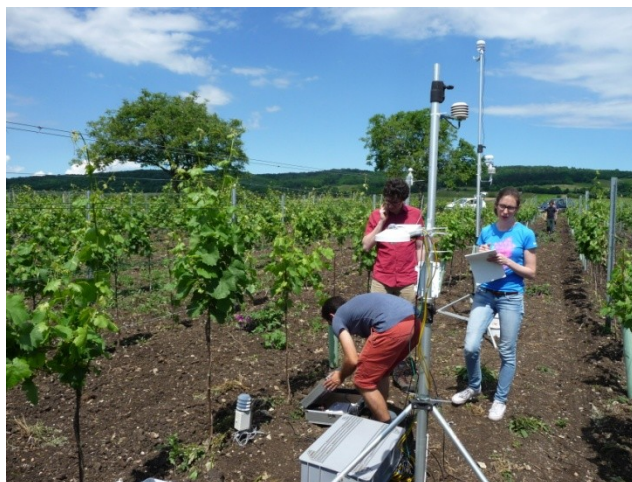
Slika 2 Stubovi za merenje temperature i relativne vlažnosti vazduha na različitim visinama.
