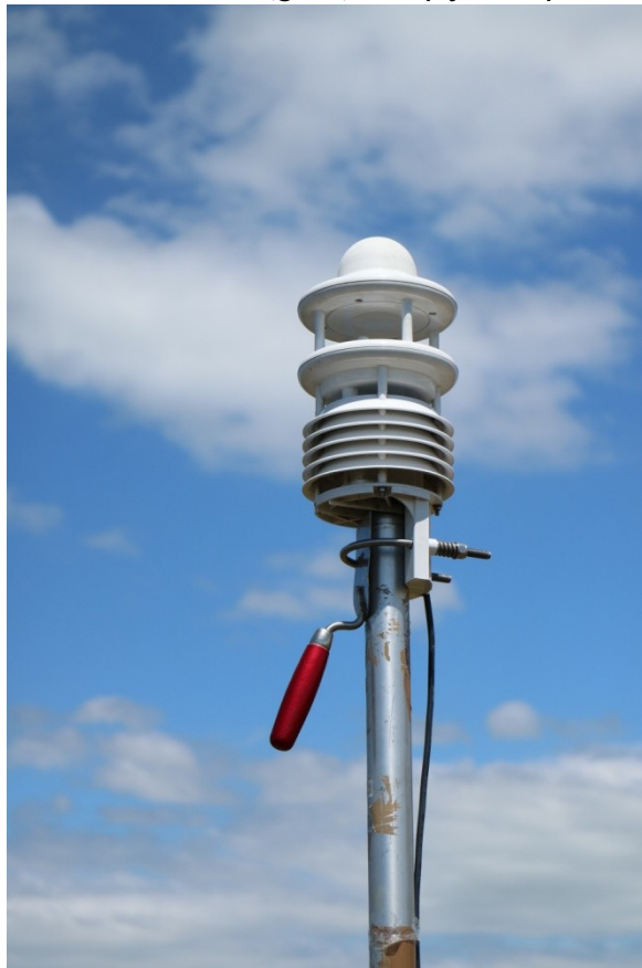
Slika 11 Kućište sa sensorima za merenje temperature i relativne vlažnosti vazduha (dole) i elektronski kišomer (gore).
