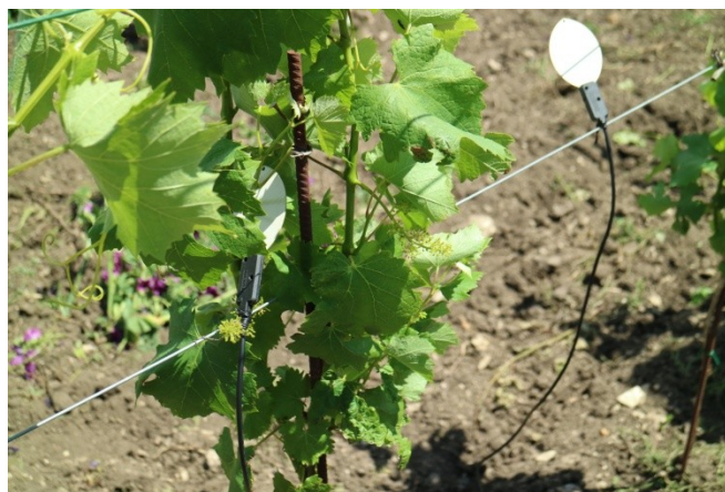
Slika 6 Poluprovodnički senzor za merenje vlaženja lista.
