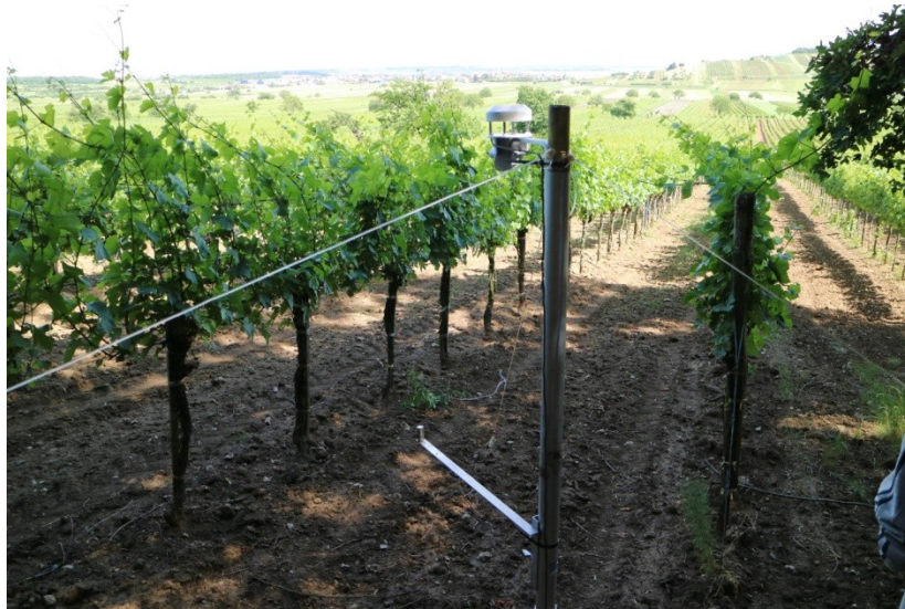
Slika 7 Merenje brzine vetra (DS2 2D-sonic anemometer from Decagon).
